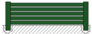
CH2: Clôture lames 80x20 Horizontales ajourées
