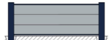
CH7: Clôture pleine lames 150x20 horizontales
