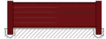
CH3.B: Clôture pleine lames 100x20 Horizontales
