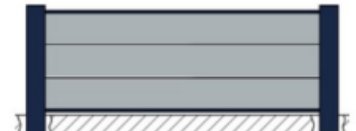
CH5.B: Clôture pleine lames 200x20 Horizontales
